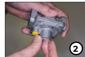
2 - DÉVISSEZ LE BOUCHON POUR ACCÉDER AU RÉGLAGE DU RÉGULATEUR.
