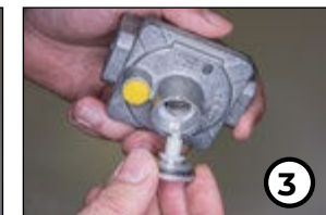
3 - L'ADAPTATEUR EN PLASTIQUE DOIT ÊTRE RETOURNÉ SELON LE TYPE D'ALIMENTATION EN GAZ.
