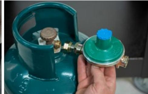
2. Avvitare il regolatore del gas nella valvola della bombola e, a mano, girare in verso antiorario il bullone. Aiutarsi con una chiave apposita per regolatore del gas per il perfetto serraggio e per evitare di danneggiare la guarnizione della valvola compromettendo la tenuta stagna.
