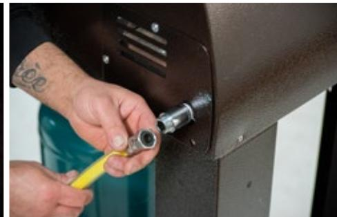
4. Avvitare il tubo flessibile al forno e aiutarsi con una chiave apposita per il perfetto serraggio.
