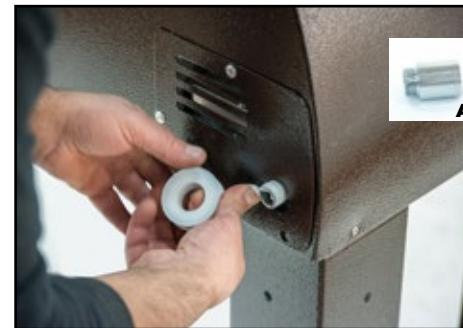
**1.** Isolare con teflon l'attacco gas forno e avvitare il connettore (A) di collegamento.
